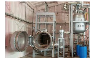
“高圧水蒸気蒸留法”は原材料から高圧水蒸気で精油や蒸留水を抽出する技術です。
